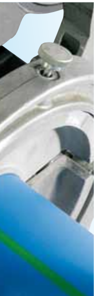
Krok 1 pripravte potrubie na zváranie na tupo: zarovnajte konce potrubia, odstráňte PE triesky a očistite potrubie s vhodným prostriedkom.
